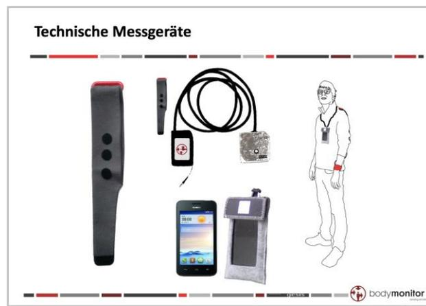
Abbildung 2. Verwendete Messinstrumente der Firma bodymonitor zur Erhebung physiologischer Daten (links), Empfänger zur Aufzeichnung der Raum-Zeitkoordinaten per GPS (oben Mitte), sowie Smartphone zur Datenerhebung per Onlinefragebogen (unten Mitte). Die rechte Zeichnung symbolisiert die Trageposition der Messinstrumente am Körper (Abbildung erstellt von bodymonitor).
